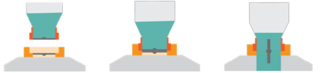
**1** Активные и пассивные блоки состыкованы. Каждая половина клапана включает в себя одну половину дискового затвора. Каждый блок герметичен и не может быть открыт, если блоки не состыкованы.
