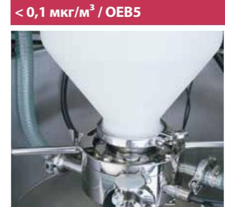
**4** Затем фиксация и активного и пассивного блоков снимается, блоки отсоединяются и области контакта становятся закрытыми, как и ранее. Таким образом, при перемещении вещества частицы не попадают в воздух.
