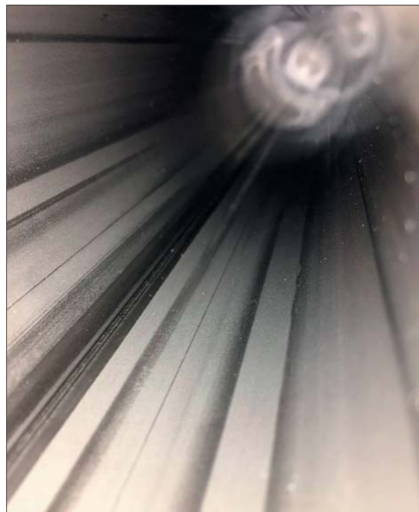
Рис. 10. Сравнение внутренней поверхности полированной трубы в соответствии с DIN 11866 со стандартной трубой по EN 10357 (DIN 11850) (одинаковые диаметры труб)
