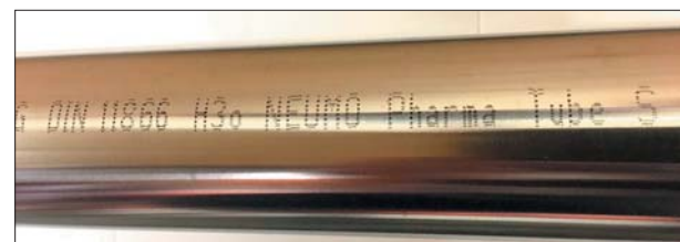
Рис. 8. Пример маркировки трубы в соответствии с DIN 11866
