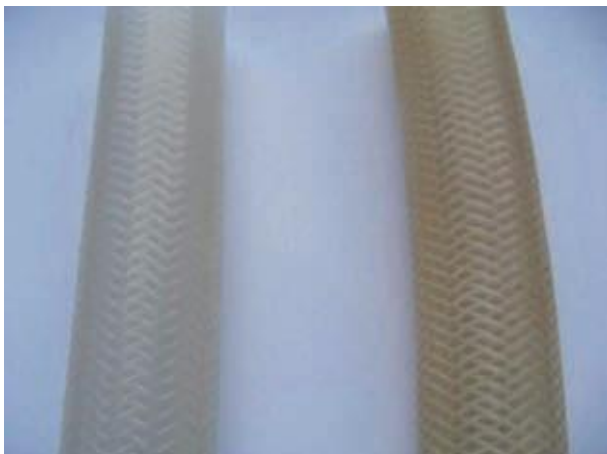
Рис. 8. Характерное изменение цвета силикона после многочисленных циклов автоклавирования
