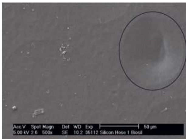
Рис. 5. Схлопнувшийся приповерхностный пузырь (в круге)
