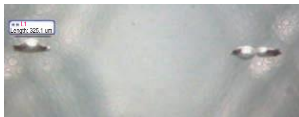
Рис. 3. Пузырьки с загрязнением в приповерхностном слое. Виден эффект «змеиной кожи» на внутренней поверхности
