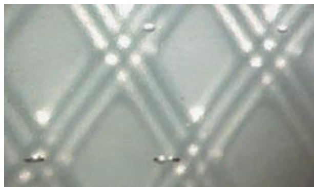
Рис. 2. Сегмент шланга с пузырьками, расположенными вблизи внутренней поверхности. Отчетливо видно, что нижние пузырьки загрязнены
