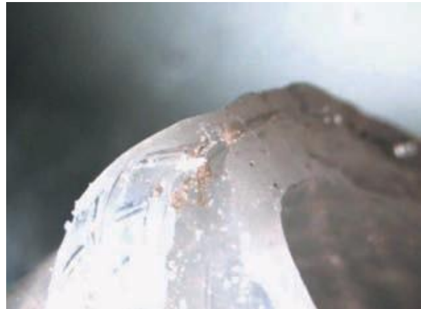
Рис. 9. Расслаивание силиконового рукава в результате автоклавирования
