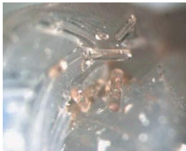
Рис. 10. Разрушение монофильной оплетки в результате автоклавирования
